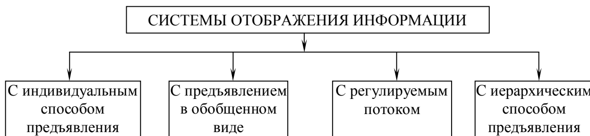
Рис. 10.4. Классификация систем отображения информации
