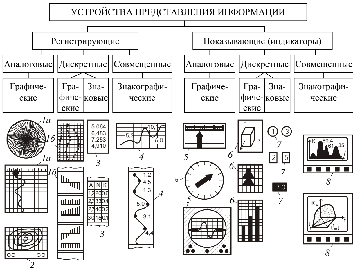
Рис. 10.5. Классификация устройств представления информации:
